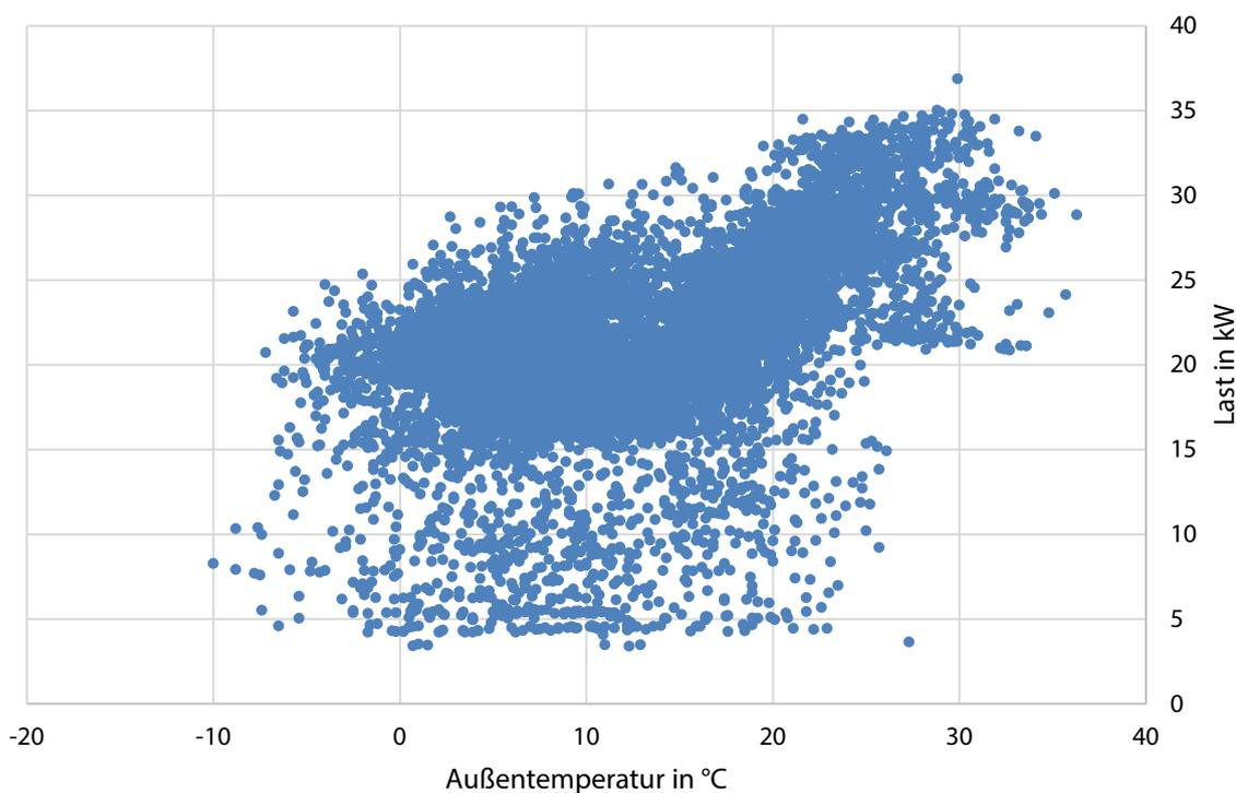
Abbildung 5: Temperaturabhängigkeit der Last im Baseline-Zeitraum (01.01.16 – 24.07.18, Öffnungszeiten)
