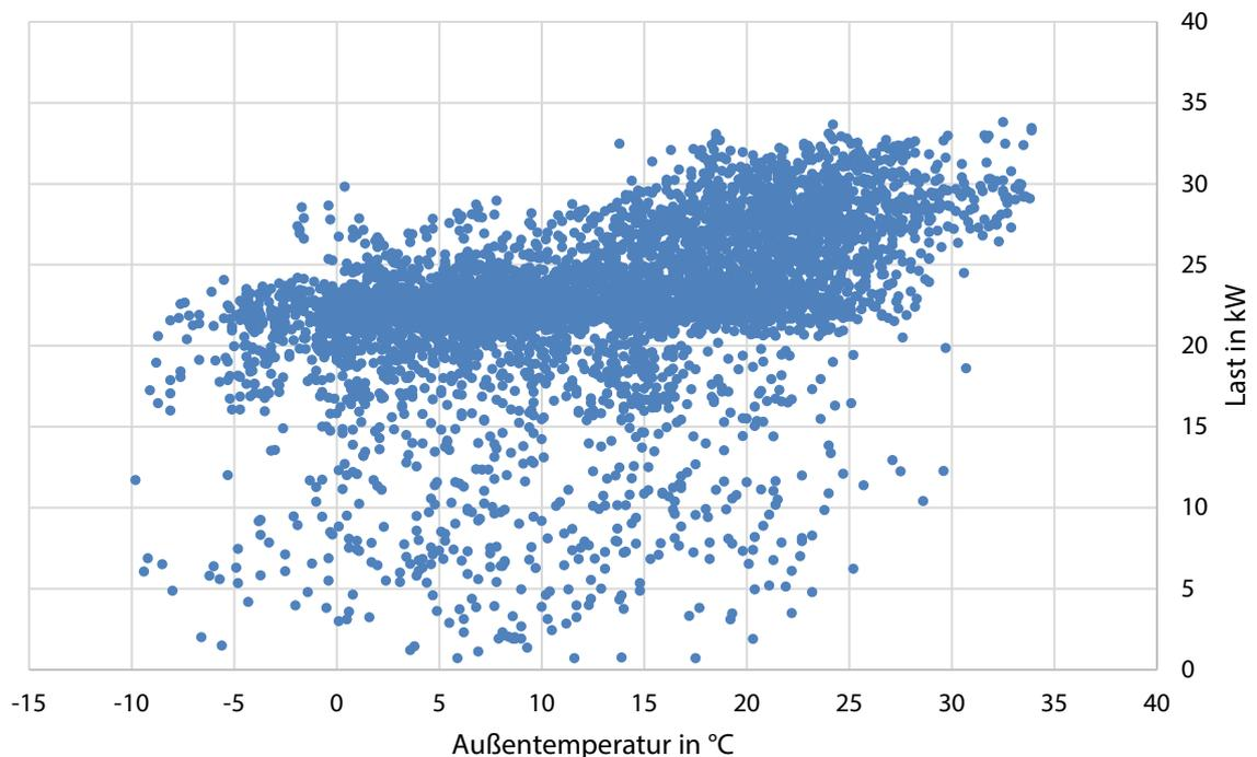
Abbildung 5: Temperaturabhängigkeit der Last im Baseline-Zeitraum (01.01.17 – 28.07.18, Öffnungszeiten)
